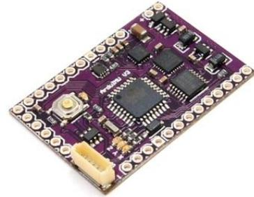
Il a été choisi pour sa facilité de mise en œuvre, c'est-à-dire que tous les capteurs sont sur la même carte. Le processeur est suffisamment puissant pour effectuer l'acquisition, le traitement et le calcul des commandes moteurs ainsi que la communication avec le sol.
